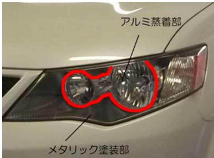
写真4. アルミ蒸着部品とメタリック塗装部品の組み合わせ例 (ブラウン系メタリック塗装事例)
