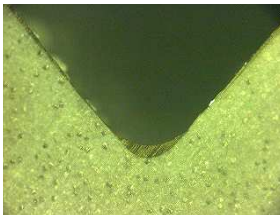
写真4. たれ、溜まりの断面写真 (左: 一般品、右: BR I GHTアンダーコートSUVシリーズ)
