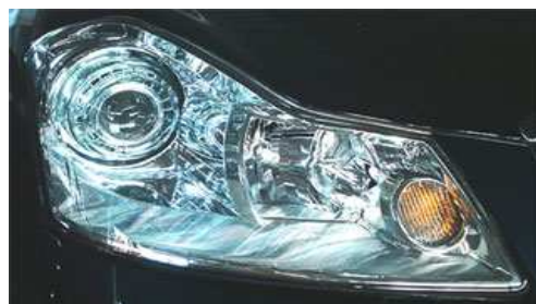
写真1. UV 硬化型プライマーを塗装したヘッドランプの例
